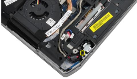
5. 将电源连接器支架从计算机卸下。
