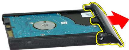
7. 从硬盘驱动器上卸下硬盘驱动器隔离程序。
