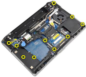
4. 翻转计算机并拧下用于将掌垫板部件固定至计算机的螺钉。
