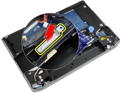
7. 断开 LVDS 电缆与系统板背面的连接。
