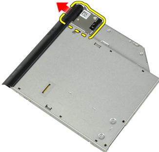
7. 拧下将光盘驱动器门锁支架固定至光盘驱动器部件的螺钉。
