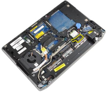
6. 断开摄像头电缆与计算机的连接。
