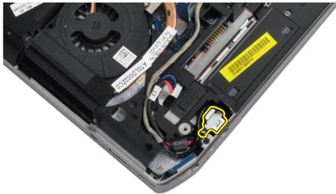
6. 从计算机中拔下电源连接器电缆。
