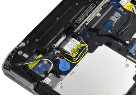
4. 拧下将 WLAN 卡固定到计算机的螺钉。
