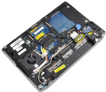
5. 上拉卡舌以断开 LVDS 电缆与计算机的连接。
