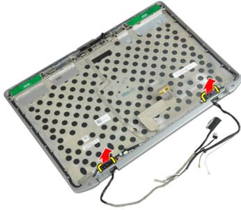
5. 拧下将显示屏铰接部件固定至显示屏部件的螺钉。
