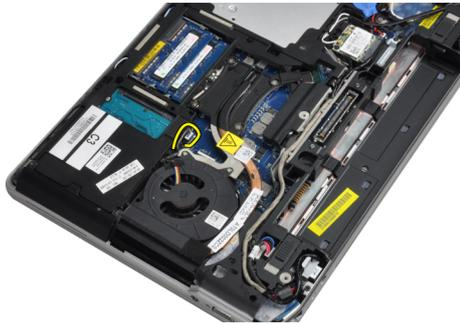
4. 拧下将散热器固定至系统板的螺钉。
