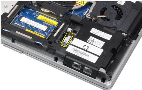
5. 断开蓝牙电缆与系统板的连接，并从计算机中卸下该卡。
