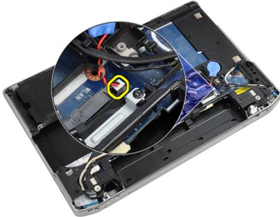
4. 断开摄像头电缆与系统板的底座连接。
