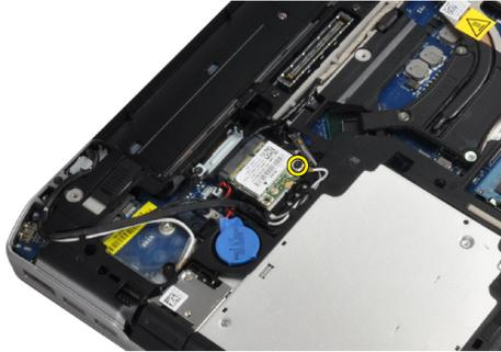
5. 将 WLAN 卡从系统板上的插槽卸下。
