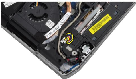
4. 拧下用于将电源连接器支架固定至计算机的螺钉。
