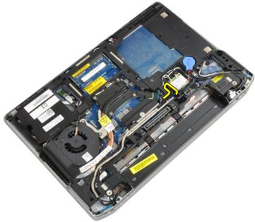
7. 从布线通道拔下 LVDS 电缆和摄像头电缆。
