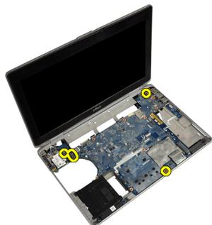
11. 轻轻提起系统板部件的左侧边缘并提起到 45 度角，再将系统板从右侧的端口连接器释放出来。
