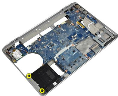
4. 将硬盘驱动器支撑板提出计算机。
