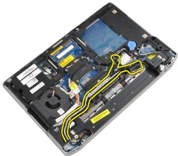
8. 断开连接到无线解决方案的所有天线。
