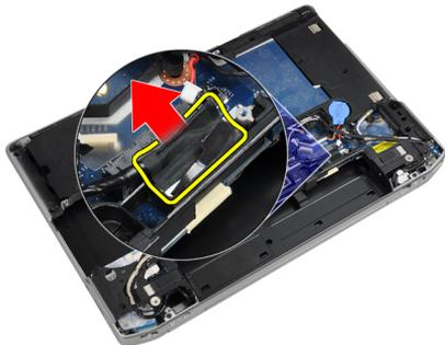
8. 断开扬声器电缆与系统板的底座连接。
