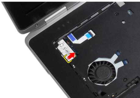
5. 使用卡舌并从插槽拉动调制解调器卡的下方右侧边缘。
