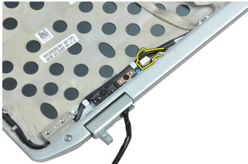
4. 拧下将电源 LED 板固定至显示屏部件的螺钉。
